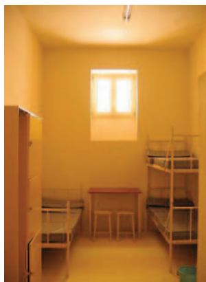
Abb. 26 Farbreflexion der gegenüberliegenden Hausfassade mit kräftigem gelbem Anstrich – im Haftraum wird das Tageslicht gelb verfärbt
